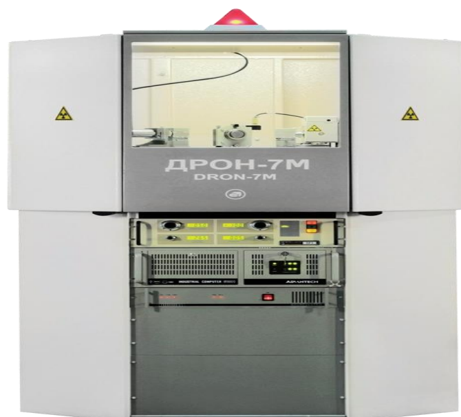
Рисунок 36. Рентгеновский дифрактометр ДРОН-7 М
