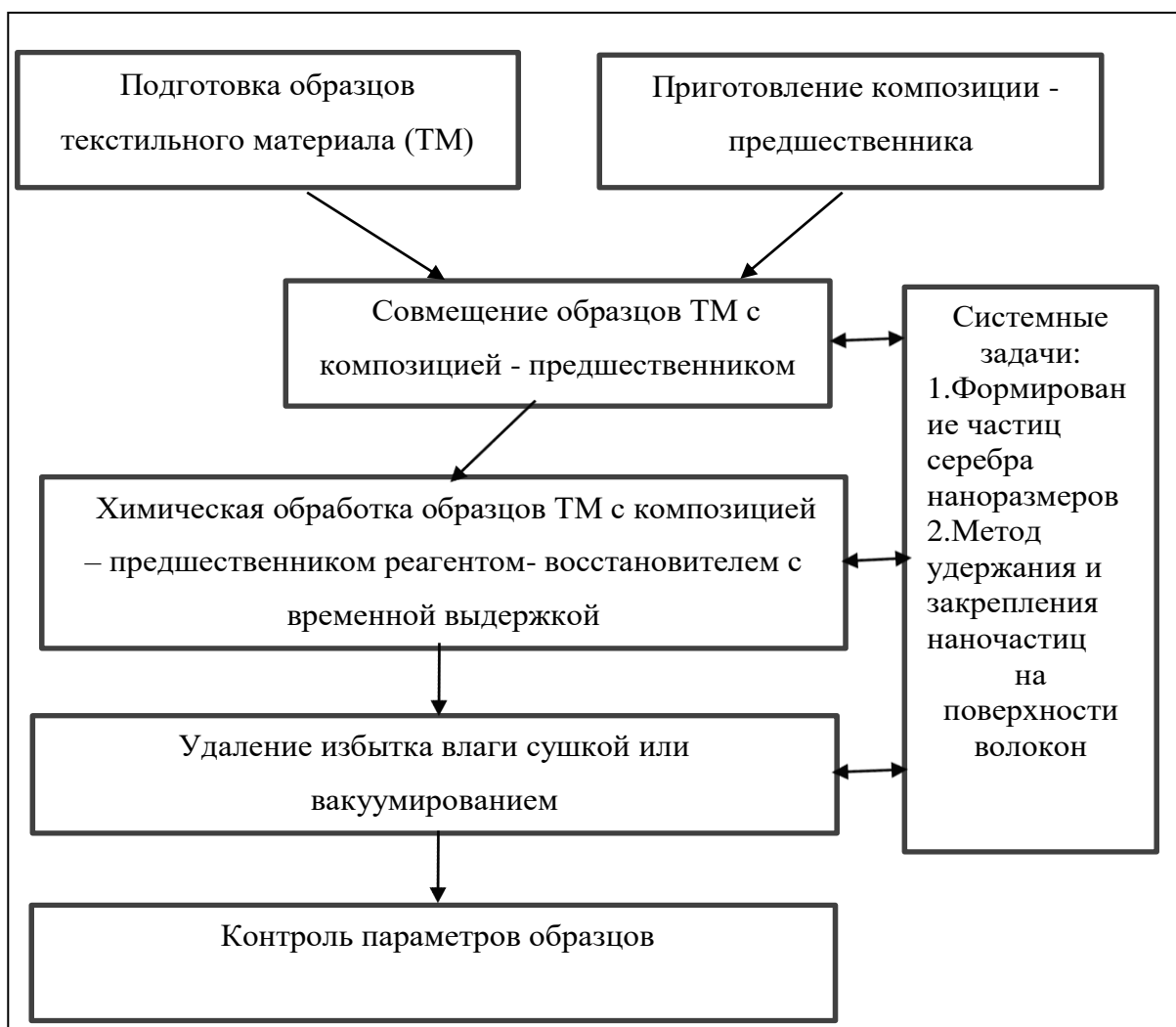
Рисунок 2. Схема процесса жидкофазной переработки текстильного материала с целью модификации материала наночастицами
