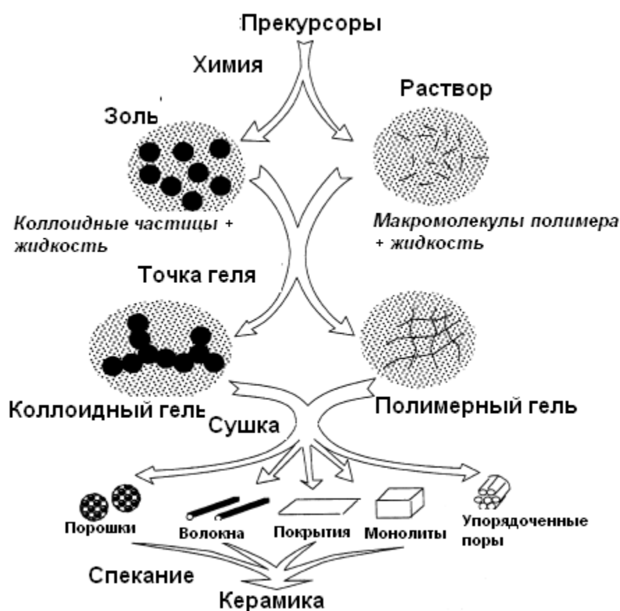
Рисунок 17. Схема золь-гель процессов создания нанокompозитов
